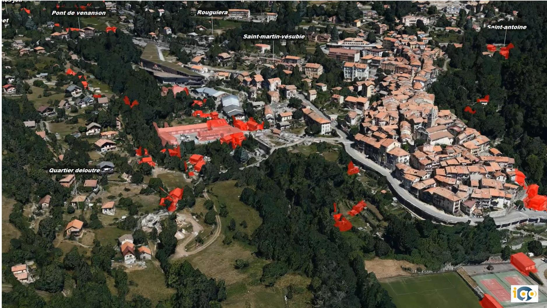
Modèle 3D de la vallée sur la base d'une prise de vue aérienne réalisée par l'IGN, puis intégration des données 3D dans un jumeau numérique et identification du bâti sinistré par IGO
