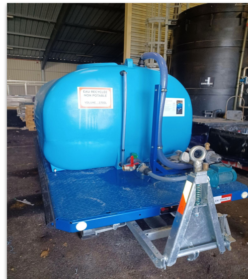
Cuve roulante de distribution d'eau recyclée
